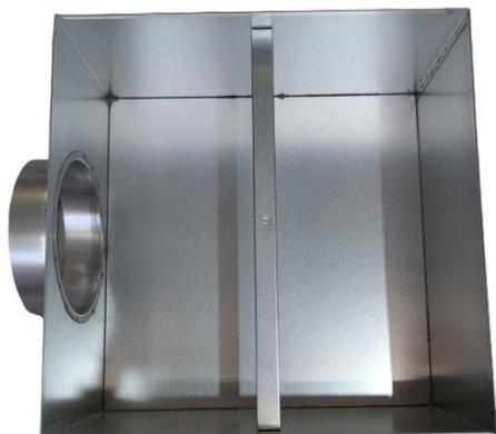
Une barre de soutien est positionnée au milieu du caisson afin de visser et fixer les grilles venant contre le plafond (généralement en 600x600mm). La fixation se fait via un filet femelle de M6.
