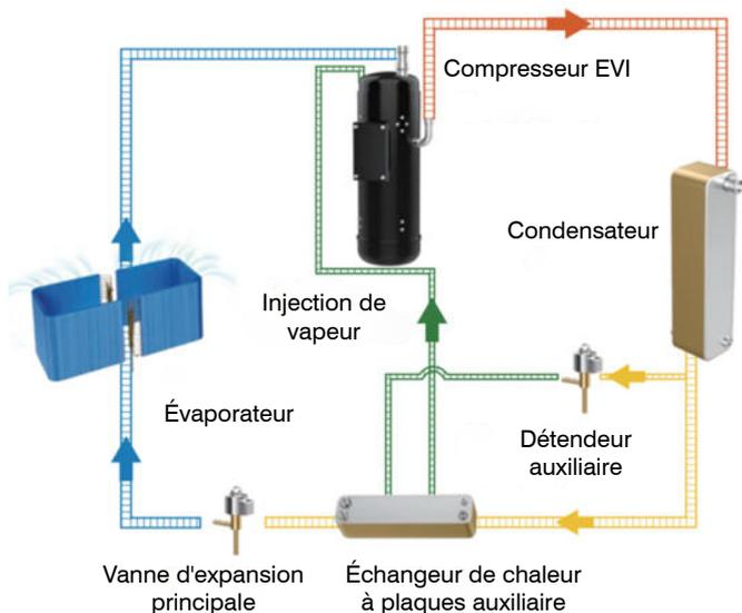
Grâce au compresseur scroll à Inverter DC EVI (Enhanced Vapour Injection) et à l'échangeur de chaleur à plaques auxiliaire, la circulation du réfrigérant et la capacité de chauffage à basse température ont été améliorées.
