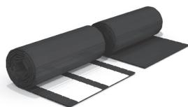
Brandwerende soepele stroken die binnen gebouwen worden geplaatst rond MEPLA kunststof leidingen ter hoogte van een wand- of vloerdoorvoering om de verspreiding van brand te voorkomen. Vanaf 100°C zet het materiaal zich uit van 2 mm tot 10-12 mm. De opzwellende stroken dichtten de luchtspleten brandwerend af, waardoor de doorvoering ook afkoelt.
