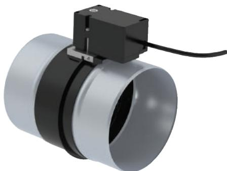
La gamme de registres motorisés RM-ME offre la possibilité d'une fermeture du canal aéraulique par une mise sous tension ou hors tension. Le retour en position initiale du volet se fait hors tension par l'action d'un ressort.
