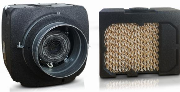
Humidificateur à conduit conçu pour les systèmes de ventilation mécanique domestique avec un débit maximum de 600m<sup>3</sup>/h. L'eau filtrée s'évapore naturellement sur une matrice spéciale, après quoi l'air humidifié est distribué dans un système de conduits de ventilation et dans les pièces connectées.
