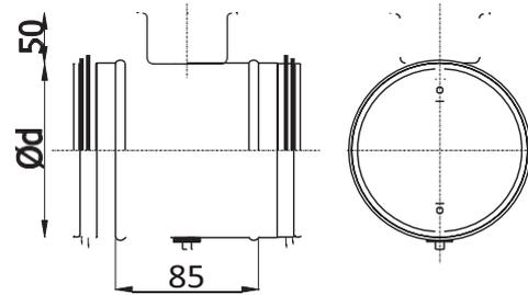
$d_1 \geq 355$  le moyen d'étranglement est monté sur une longue tige
