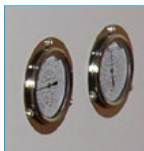
2. Manómetros integrados en el carrozado
