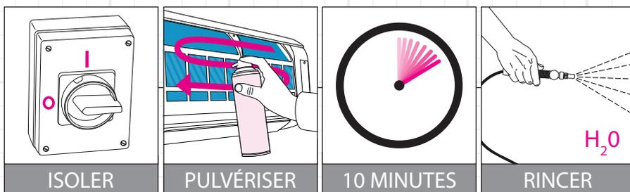
Isoler les circuits électriques. Pulvériser le produit en commençant par le haut, puis en allant de droite à gauche et progressivement vers le bas. Bien imbiber le serpentin. Laisser détrempé pendant 10 minutes. S'assurer qu'EasyCare™ a bien pénétré à l'intérieur du serpentin. Rincer abondamment à l'eau claire.
